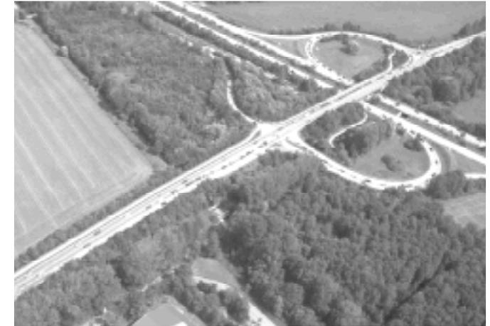
Mit Errichtung des Anschlussbauwerks an die A92 wird die B471 nach Norden verschoben und gewinnt somit Abstand zum Kanal. Im Gehölzbestand ist noch die erst kürzlich beseitigte Schwebelbachbrücke der alten B471 zu erkennen
